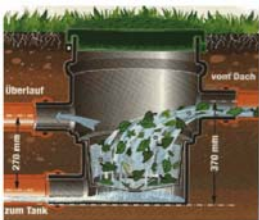
Siebfilter, Filterkorb - muß gereinigt werden
